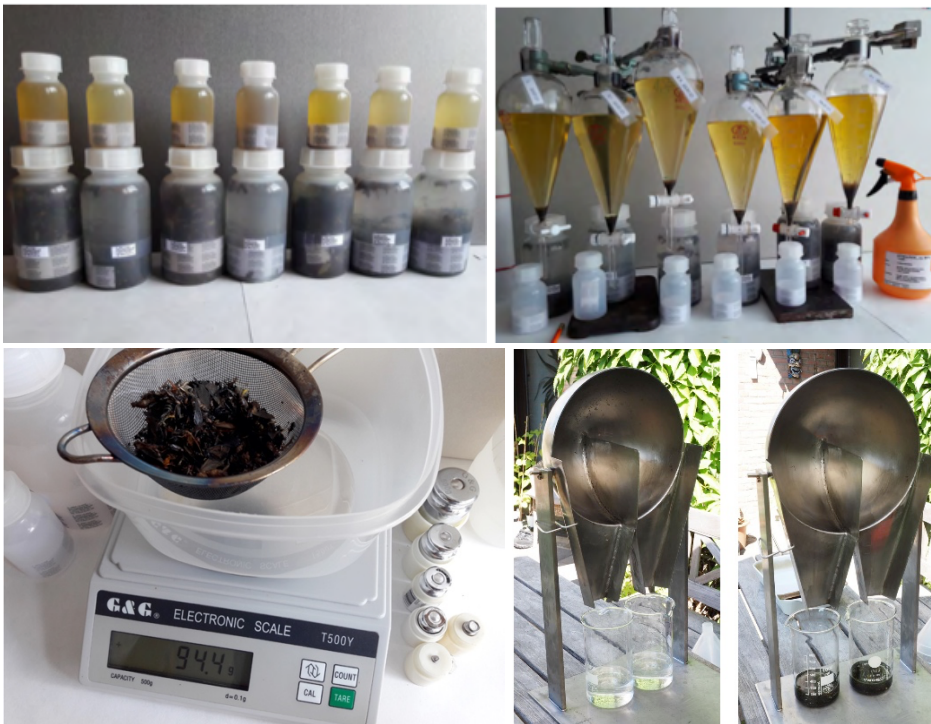
Abb. 3: Aufbereitung der Insektenproben beim EVK. Von links oben nach rechts unten: Etikettierungen und Biomassenbestimmung, Messung der Alkohol-Konzentrationen, Probenteilung (Fotos: EVK).
